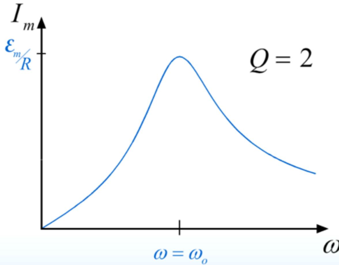
$$x \equiv \frac{\omega}{\omega_o} \quad Q^2 \equiv \frac{L}{R^2 C}$$
